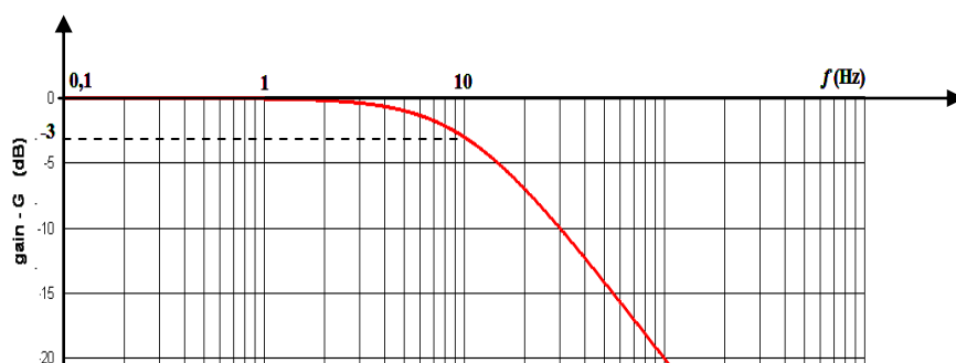
Figure 15 : Réponse en fréquence du filtre
