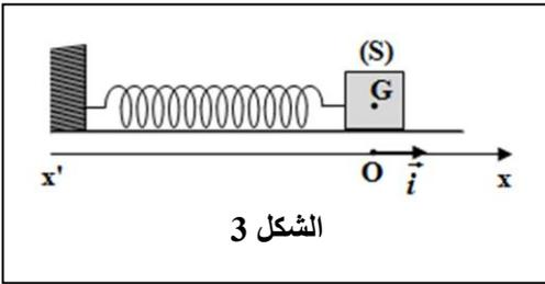
نختار الحالة التي يكون فيها النابض غير مشوه، مرجعا لطاقة الوضع المرنة  $E_{pe}$ ، والمستوى الأفقي الذي يشمل G مرجعا لطاقة الوضع الثقالية  $E_{pp}$ . يمثل الشكل (4) تغيرات كل من طاقة الوضع المرنة  $E_{pe}$  والطاقة الحركية  $E_c$  بدلالة الزمن للمتذبذب المدروس.
